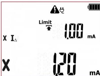
Falsches Ergebnis. Der Wert liegt außerhalb des gesetzten Grenzwertes des  $I_{\Delta}$  Stromes. Die roten LEDs der FAIL Anzeige leuchten.
