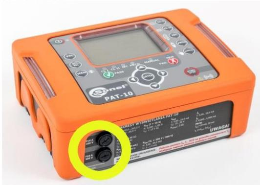
Als nächstes ersetzen Sie die Sicherung durch eine Neue, schrauben Sie diese dann zusammen mit dem Sicherungshalter wieder in das Prüfgerät.
