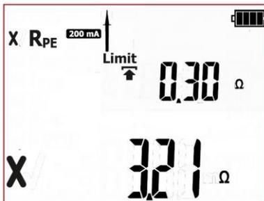
Falsches Ergebnis. Der Wert liegt außerhalb des gesetzten Grenzwertes des PE Widerstandes. Die rote LEDs der FAIL Anzeige leuchten.
