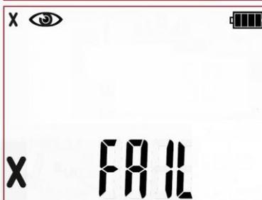
Negative Sichtprüfung. Rote LEDs der FAIL Anzeige leuchtet.
