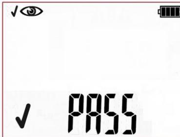
Positive Sichtprüfung. Grüne LEDs der PASS Anzeige leuchtet.
