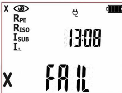
Negatives Ergebnis der Sichtprüfung: es werden keine weiteren Messungen durchgeführt. Die roten LEDs für die FAIL Anzeige leuchten. Rechts wird die aktuelle Zeit angezeigt.
