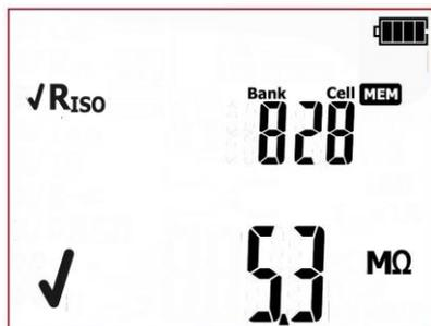
Eine Zelle, belegt mit einer Einzelmessung. Ein Symbol zeigt die Art der Messung und das Messergebnis am Display an.
