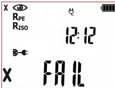
Negatives Ergebnis der Sichtprüfung; es werden keine weiteren Messungen durchgeführt. Die roten LEDs für die FAIL Anzeige leuchten. Rechts wird die aktuelle Zeit angezeigt.
